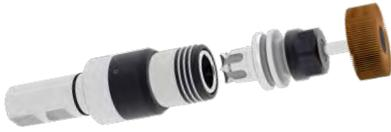
Das Schnellwechselsystem kann unabhängig von der Rotationslage der Antriebsspindel gekuppelt und entkuppelt werden. Nach Erreichen des Magazinplatzes ist zum Kuppeln lediglich eine axiale Bewegung in Richtung Wechseleinsatz nötig. Eine axiale Bewegung in die entgegengesetzte Richtung entkuppelt den Wechseleinsatz.
