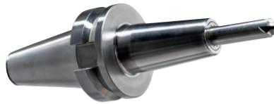
Richtungsweisend in der Kühlmittelzufuhr – ThermoGrip® Corona Jet bietet eine neuartige Kühlmittelzufuhr über in der Futterstirnseite integrierte, geneigte Düsen, welche direkt auf die Schneide ausgerichtet sind. Die Abmaße der Corona Jet Futter sind identisch mit ganz normalen Standardschrumpffuttern. Lediglich an der Stirnseite ist der Düsenring zu erkennen.
