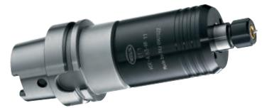
Sicherheitsteile wie z.B. ABS – Bremsen für PKW's müssen eindeutig identifiziert werden können. Da diese Teile auf Bearbeitungszentren meist komplett gefertigt werden, wird die Kennzeichnung während der Produktion vorgenommen. Das Bilz-Sonderwerkzeug ET1 wird wie ein Bearbeitungswerkzeug in die Maschinenspindel eingewechselt. Die kugellagerte Werkzeugspindel, mit einer Kugelschreibermine versehen, hat einen Axialweg von 10 mm und ist mit einer bestimmten Kraft vorgespannt.
