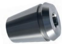
Mit TER wird der Belastungseffekt durch Unwucht des Werkzeugs nahezu eliminiert. Äußerst exakt in das Zentrum der Spannbohrung eingespannt, läuft das Werkzeug optimal rund und bildet in eingeschrumpftem Zustand eine kurze und stabile Einheit mit der TER-Spannzange.
