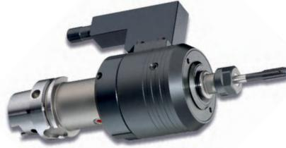
Hochleistungs-Gewindeschneidapparat mit integriertem Wendegetriebe. Bilz Gewindeschneidapparate sind modular aufgebaut und können dadurch maschinenspezifisch angepasst werden. Sie sind auf Bearbeitungszentren mit automatischem Werkzeugwechsel sowie auf Sondermaschinen einsetzbar.
