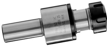
Bilz Pendelhalter ermöglichen das serienmäßige Herstellen passgenauer Bohrungen, die größtmögliche Schonung der Reibahle sowie die automatische Zentrierung der Reibahle nach jedem Arbeitsgang. Pendelhalter sind horizontal und vertikal einsetzbar sowie mit und ohne innere Kühlmittelzufuhr und integrierter Längennachstellung lieferbar.
